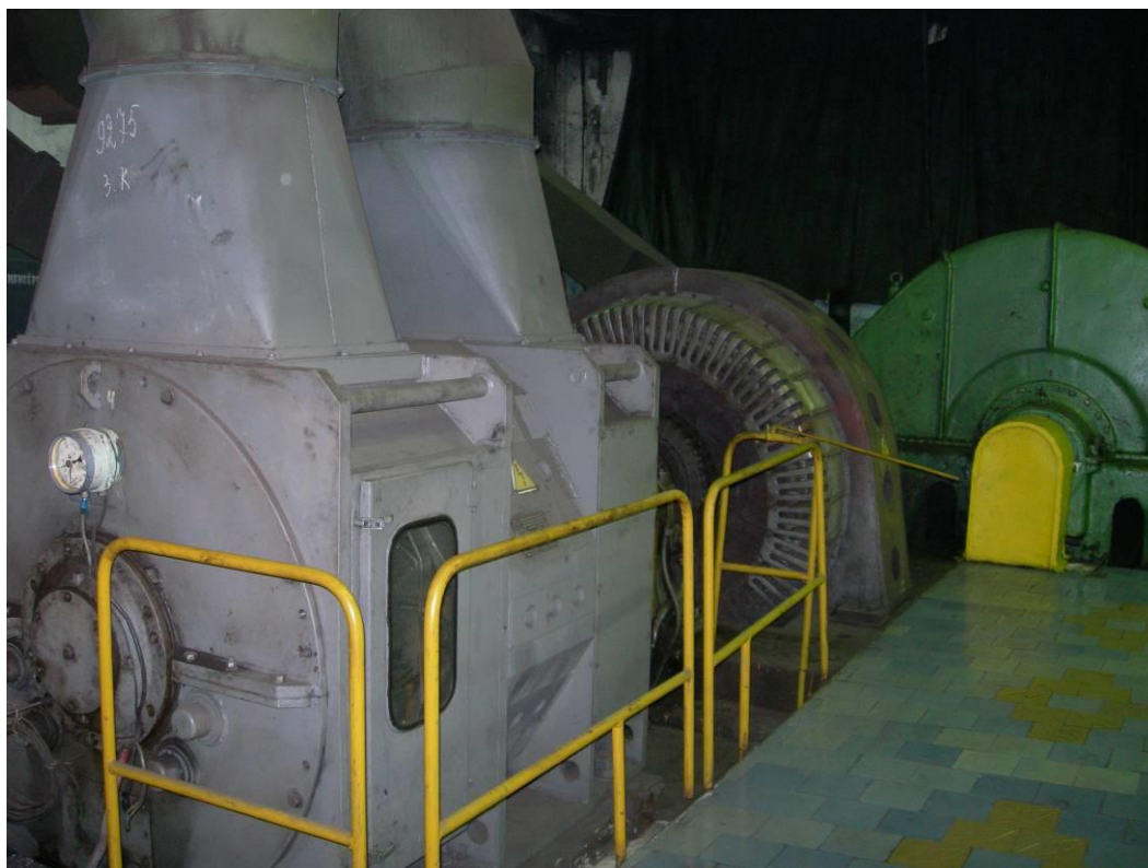
Рис. 3. Общий вид стана Шихау (со стороны привода)
