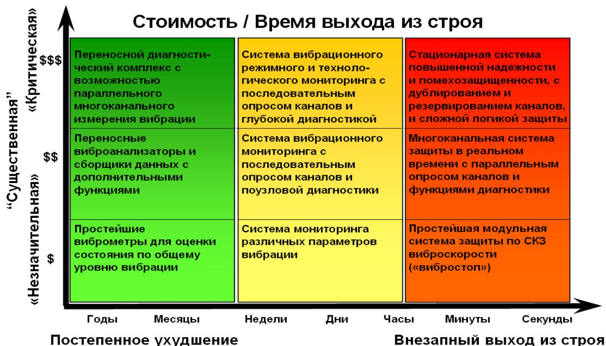
*Рис. 2. Диаграмма выбора оптимального технического решения для контроля различных групп роторного оборудования.*
