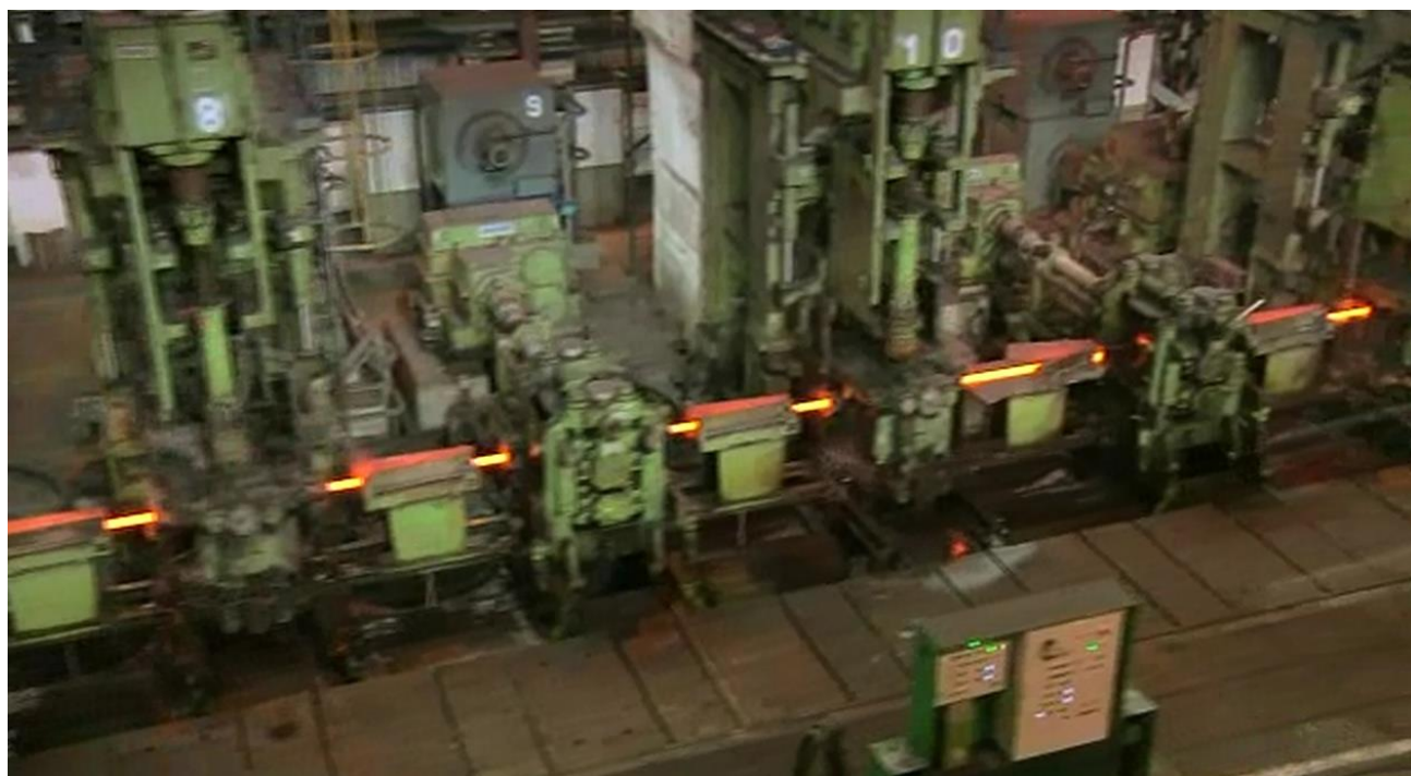
Рисунок 1 – Общий вид привода валков прокатной клетки: а) вертикальных или горизонтальных (чистовой группы); б) вертикальных черновой группы; в) участок промежуточной группы клеток
