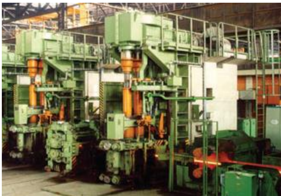
Рисунок 1 – Общий вид привода прокатной клетки с комбинированным редуктором
